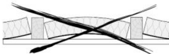
Figure 17 – Pose incorrecte en panneau
